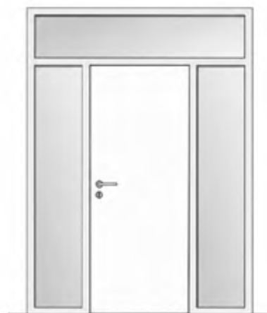
2 feststehende Seitenteile mit Oberlicht
